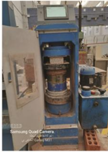
اجراء اختبارات التحميل على الطوب المصمت
