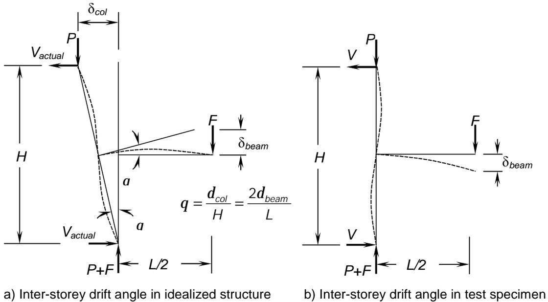
**Fig. 5: Inter-Storey Drift Angle**
