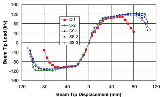
**Fig. 11: Load-Displacement Envelopes**
